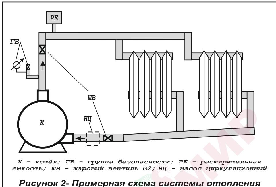
**Рисунок 2- Примерная схема системы отопления**
